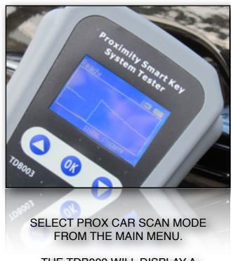
THE TDB003 WILL DISPLAY A ROLLING SIGNAL WAVEFORM TO SHOW THE CAR SIGNAL ONLY.
