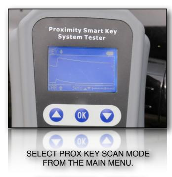
THE TDB003 WILL DISPLAY A ROLLING SIGNAL WAVEFORM TO SHOW THE KEY SIGNAL ONLY.
