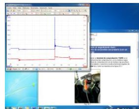
La barra de herramientas superior muestra los controles del osciloscopio que se usan con más frecuencia. Ambos canales se controlan con los menús desplegables de base temporal:
