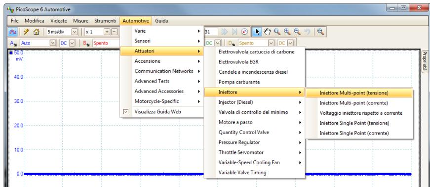
Questo menu a discesa visualizza una scelta delle misurazioni comuni eseguibili con il kit Automotive. Quando si seleziona una delle opzioni di misurazione dal menu **Automotive**, PicoScope automaticamente:
