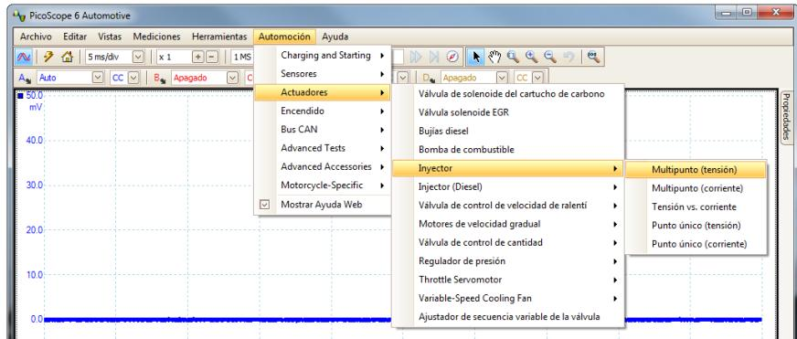
Este menú muestra un conjunto de mediciones habituales que se pueden realizar con el kit de automoción. Al seleccionar una de las opciones de medición del menú, PicoScope automáticamente:
