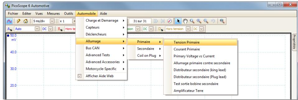
Ce menu déroulant présente une sélection des mesures communes pouvant être relevées en utilisant le kit pour automobile. Lorsque vous choisissez des options de mesure dans le menu **Automobile**, PicoScope va automatiquement :
