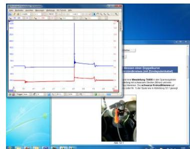
Die obere Symbolleiste enthält alle häufig benutzten Steuerelemente für das Oszilloskop. Beide Kanäle werden von den Zeitbasis-Dropdown-Menüs gesteuert:
