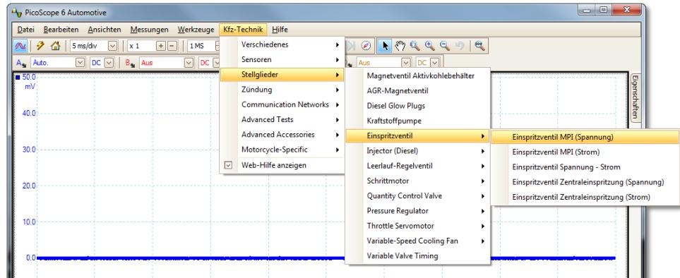
Dieses Dropdown-Menü zeigt eine Auswahl der gebräuchlichsten Messungen, die mit dem Kfz-Kit ausgeführt werden können. Wenn Sie eine der Messoptionen aus dem Menü **Kfz-Technik** wählen, wird PicoScope automatisch:
