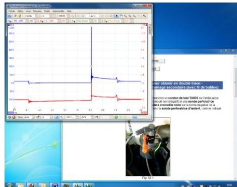
La barre outil en haut de l'écran comporte les commandes utilisées les plus fréquemment pour l'oscilloscope. Les canaux sont commandés par les menus déroulants base de temps.
